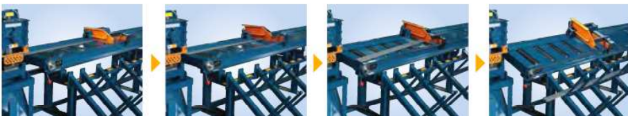
切断後はスイッチにて送出コンベアが傾斜し、切断材をストックに落とします。
