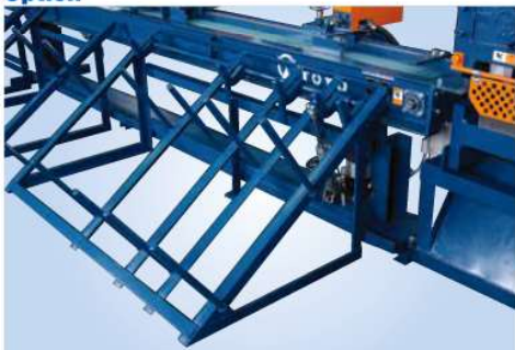
ストック待機アームは、切断後の製品を一時的に仮受けさせ、結束後、製品ストックに落とすことができます。(オプション)
