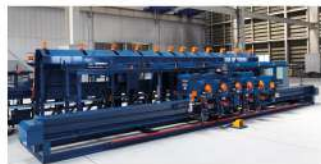
Máy uốn cốt thép tự động
